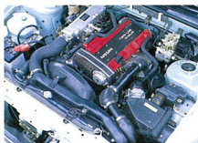
▲シルビアK'sのエンジンルーム。CA18 DE型エンジンの赤いシンダーヘッドカバーが印象的。
