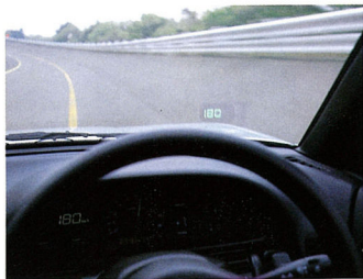
▲フロントウインドウ・ディスプレイは、ガラス面右下方のコンバイナー=反射膜に車速をデジタル映写する。写真はテストコースを180km/hで走行中に撮影したもの。
