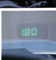
▲フロントウインドウ・ディスプレイは、ガラス面右下方のコンバイナー=反射膜に車速をデジタル映写する。写真はテストコースを180km/hで走行中に撮影したもの。
