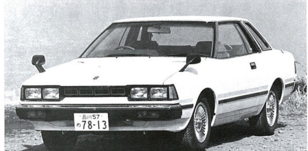
▲昭和54年3月に発表された3代めモデル。リヤサスがリジット・リーフから4リンク コイルに変わった。
