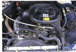
▲MB180Eのエンジンルーム。搭載されるエンジンはSOHC 4気筒、1995ccの1J26型。KEジェトロニックの燃料噴射で出力/トルクは115ps/17.5kgm。
