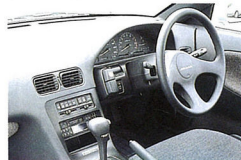
▲K's 4速AT車のインストルメントパネル。インパネからスムーズな傾斜でセンターコンソールに流れこむ大きな面が印象的だが、この面は一体成型で作られていて豪勢な感じを与える。
